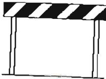
FIG.392 "Interruzione" Barriera Normale delle dimensioni 150x20 cm in Classe 1°
